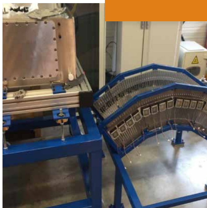
Montage des différents éléments du détecteur ACTAR TPC
